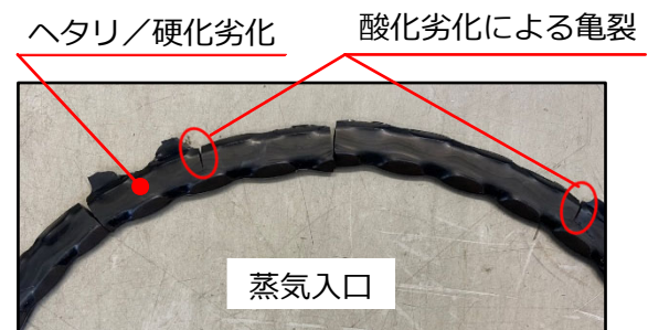
蒸気側ガスケット (A部拡大)
