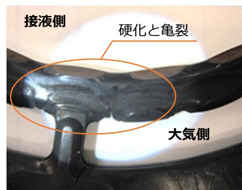
蒸気ブロードレン入口側ガスケット B 部拡大
