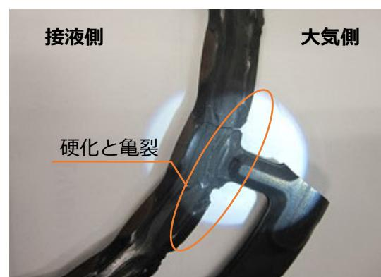
蒸気ブロードレン入口側ガスケット A 部拡大
