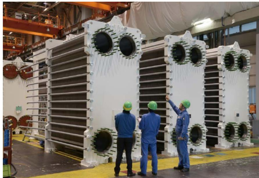
世界最大級のプレート式熱交換器 UX-160
