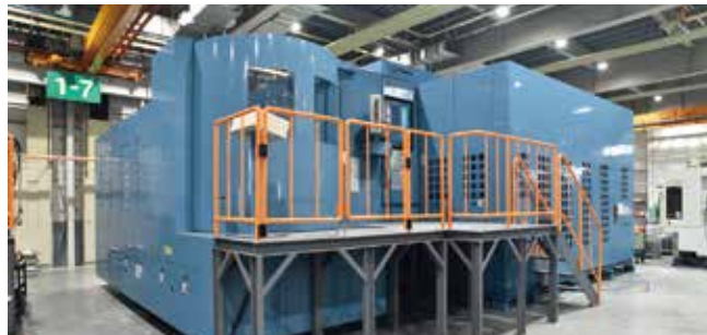
バルブ事業本部 縦型5軸複合加工機 大口径バルブの本体加工を行う数値制御式複合加工機です。多面加工が可能で、工程のムダを削減でき、さらに加工寸法精度が向上しました。
