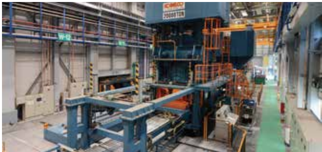
熱交換器事業本部 2万トン自動プレスライン 従来比1.5倍の生産性を実現した最新鋭の全自動無人プレスラインです。中型から大型まで幅広いプレートサイズに対応できます。
