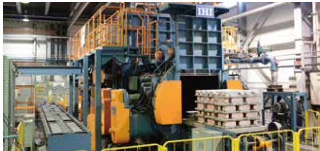
熱交換器事業本部 大型連続真空加熱炉 最大処理荷重2,000kgを誇る世界最大級の大規模連続真空加熱炉です。ブレーシングプレート式熱交換器のろう付に使われます。
