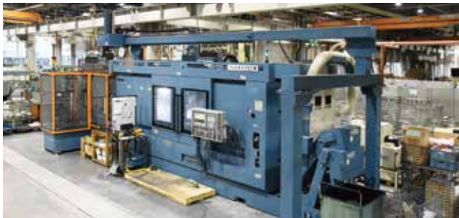
バルブ事業本部 マルチタスク加工機 無人運転でボールバルブの製造ができるマルチタスク加工機です。24時間運転で、短納期化を可能にしました。
