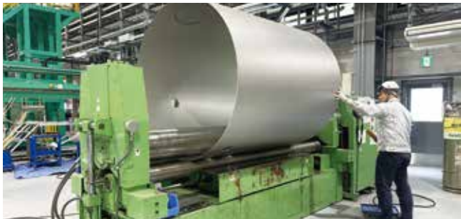
プロセスエンジニアリング事業本部 ベンディングローラー さまざまな厚みのステンレスを正確に曲げ加工する設備です。殺菌機や滅菌機、染色機の製作に欠かせない加工技術が高品質な製品づくりを支えています。
