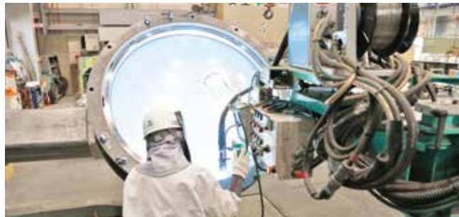
プロセスエンジニアリング事業本部 ステンレス用高精度自動溶接機 殺菌機や滅菌機、染色機の製缶で活躍する高精度自動溶接機です。日本で最初に開発し、圧力容器の自動溶接を実用化しました。スーパーステンレスなど新素材にも対応できます。
