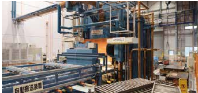
熱交換器事業本部 4万トン自動プレスライン 成形プレス・割れ検査装置・搬送装置で構成された世界最大級の4万トン自動プレスラインです。LNGプラントなどで使用されるプレートをはじめ、さまざまな大型チンプレートを生産しています。
