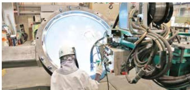
プロセスエンジニアリング事業本部 ステンレス用高精度自動溶接機
