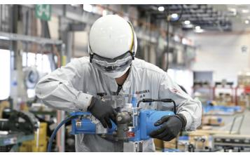
バルブを自動で動かす装置、アクチュエーターを取り付けます。
