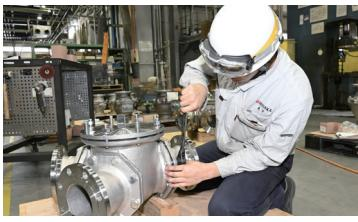
加工された部品をボルトを使って、組み立てます。
