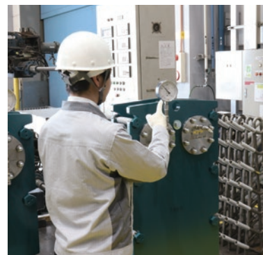
完成検査 メンテナンスの終わったプレートを整備されたフレームに組み込み所定の寸法まで締め付けて、圧力検査をして漏れのないことを確認して出荷します。
