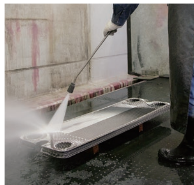
ジェット洗浄作業 洗浄槽で除去しきれなかった強固な汚れはジェット洗浄にて除去します。さらに強固な汚れはブラシなどでこすり落とします。
