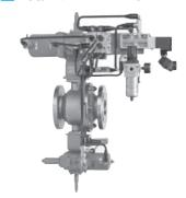
ボール回転時、ボールシートとボールが摺動しない画期的なボールバルブです。ボールとボールシートが摺動しないため、従来のボールバルブと比較し、作動トルクが軽く、摺動による傷や摩耗が発生しません。摩耗性の激しい粉粒体の輸送、粉体・スラリーを含む流体を高頻度で開閉されるような過酷な条件下での長寿命化を実現して
