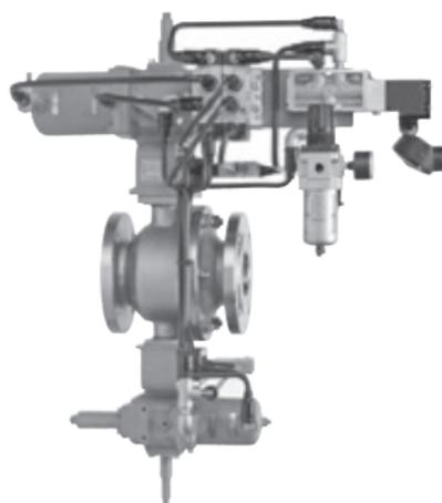
ボール回転時、ボールシートとボールが摺動しない画期的なボールバルブです。ボールとボールシートが摺動しないため、従来のボールバルブと比較し、作動トルクが軽く、摺動による傷や摩耗が発生しません。
