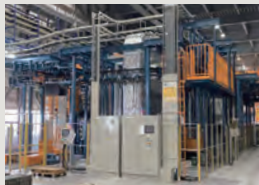
【小型フレーム粉体塗装装置】
