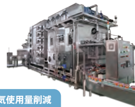
全自動連続殺菌冷却装置「リフトスチーマーZ」
