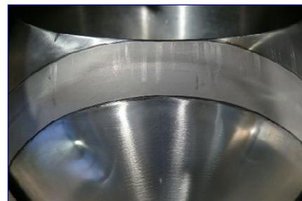
【写真②】部分硬化処理（ボール球面）
