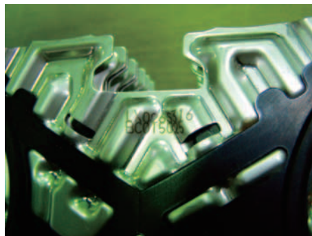
↑プレートのロット表示部分。型式LX-026、S316はSUS316であることを示しています。
