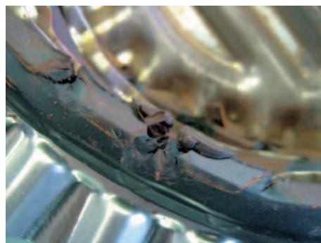
↑劣化したガスケット
