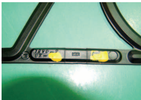
↑ロットNO.の刻印と黄色いマーキングで、NBRであることが確認できます。
