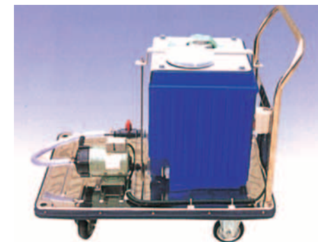
↑ CIP洗浄装置…キャスター付き簡易移動式の定置洗浄装置(CIP)です。プレート式熱交換器の定置洗浄を行います。
