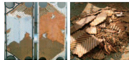
↑プレート内部で固化したハードスケール
