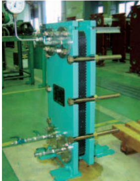
完成検査 全ての工程終了後、所定の圧力まで昇圧後、外漏れのないことを確認して合格となります。
