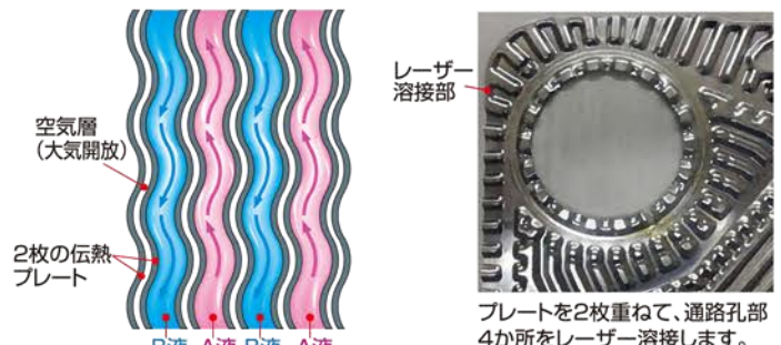
2枚の伝熱プレートの間には空気層があるので、2液混合の心配はありません。
