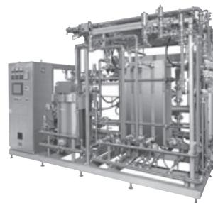
高粘度・固形物含有薬品の連続殺菌、無菌充填に適合。伝熱のエレメントにはチューブ、プレート、コルゲートを採用。真空ホールディングチューブなど、処理液の品質を守る高度なシステムです。また、この技術は飲料、乳飲料、調味料、アルコール類など幅広い液の殺菌に利用されています。
