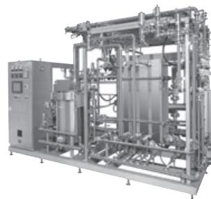
高粘度・固形物含有薬品の連続殺菌、無菌充填に適合。伝熱の元素にはチューブ、プレート、コルゲートを採用。真空ホールディングチューブなど、処理液の品質を守る高度なシステムです。また、この技術は飲料、乳飲料、調味料、アルコール類など幅広い液の殺菌に利用されています。
